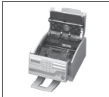
4. Ziehen Sie den Kunststoffhebel auf der rechten Seite der Tonerkassette nach vorne. Die Kassette wird entriegelt.
