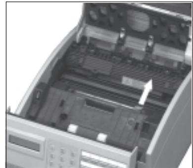
18. Schließen Sie den Gehäusedeckel, und klappen Sie den Dokumenteneinzug nach hinten.
