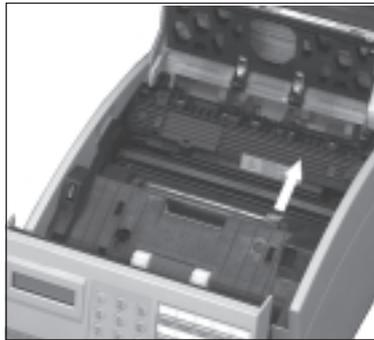
10. Klappen Sie den Gehäusedeckel wieder nach unten, und schließen Sie den Dokumenteinzug. Reinigen Sie nun die LED-Zeile wie nachfolgend beschrieben.
