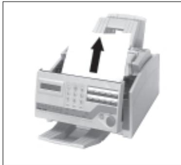
2. Öffnen Sie den Gehäusedeckel, indem Sie ihn an den beiden seitlichen Griffen anfassen und nach oben klappen.
