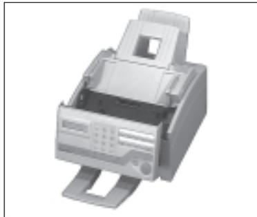
3. Öffnen Sie den Gehäusedeckel, indem Sie ihn an den beiden seitlich angebrachten Griffen anfassen und den Deckel nach oben klappen.
