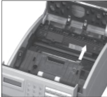
14. Klappen Sie den Gehäusedeckel nach unten, und schließen Sie den Dokumenteneinzug.
