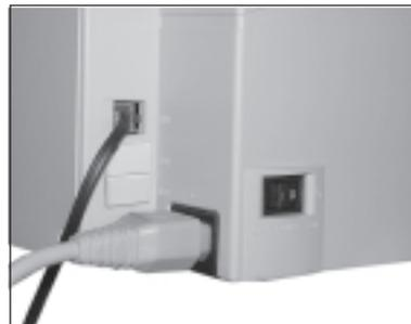
*Bei einer A12-Dose verwenden Sie die obere Buchse.*
