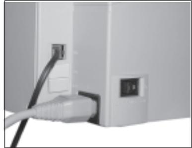
*Verwenden Sie bei einer NFN-Dose die linke Buchse.*
