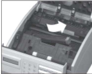
5. Heben Sie die Bildtrommeleinheit an der Vorderseite an und kippen Sie sie leicht, um sie aus den beiden Halterungen zu lösen.
