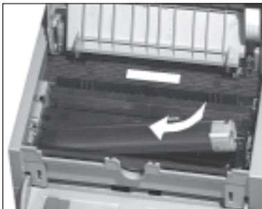
9. Schieben Sie nun mit etwas Druck den Hebel am rechten Ende der Tonerkassette nach hinten (Rückseite des Faxgerätes). Hierdurch wird die Tonerkassette verriegelt und der Schlitz auf der Unterseite der Kassette geöffnet.
