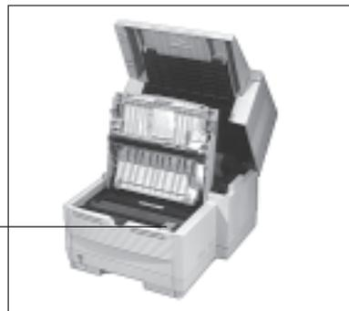
4. Heben Sie die Tonerkassette aus dem Gerät. Legen Sie die Kassette auf eine schmutzempfindliche Oberfläche oder ein Blatt Papier, da Toner herausrieseln kann.
