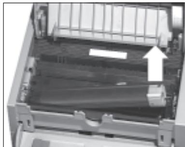
*Die Tonerkassette für dieses Faxgerät ist mit **Type 5** gekennzeichnet; sie kann ausschließlich in diesem Faxgerät verwendet werden.*
