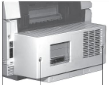
6. Entfernen Sie die beiden Schrauben.
