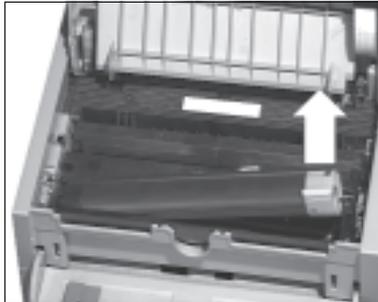
5. Fassen Sie die Bildtrommeleinheit an der Vorderseite an und heben Sie die Einheit aus dem Faxgerät heraus. Legen Sie die alte Bildtrommeleinheit zunächst zur Seite.
