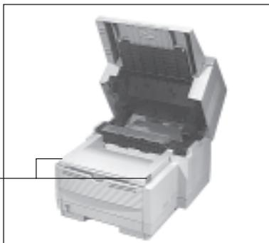
3. Öffnen Sie den Gehäusedeckel, indem Sie die beiden seitlich angebrachten Entriegelungstasten drücken und den Deckel nach oben klappen.
