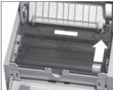
10. Schließen Sie den Gehäusedeckel; die beiden Entriegelungstasten müssen einrasten. Klappen Sie den Dokumenteneinzug herunter. Reinigen Sie danach die LED-Zeile wie nachfolgend beschrieben.
