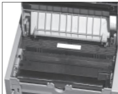
8. Halten Sie die Tonerkassette waagrecht über die Kassettenmulde der Bildtrommeleinheit. Setzen Sie die Tonerkassette in die Mulde ein; die Kassette muß dabei zuerst unter die linke Führung gelegt werden. Richten Sie die Aussparungen an der rechten Seite der Tonerkassette mit den Führungsschienen auf der rechten Seite der Mulde in der Bildtrommeleinheit aus.
