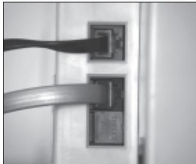
4. Verbinden Sie die mittlere und die untere Buchse an der Rückseite des Faxgerätes mit dem kurzen Verbindungskabel.
