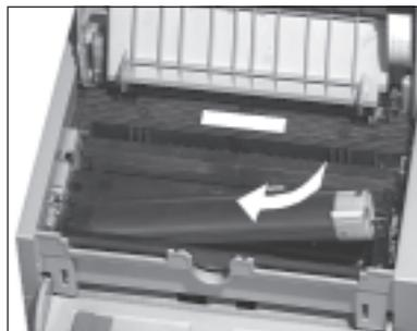
9. Schieben Sie nun mit etwas Druck den grauen Hebel am rechten Ende der Tonerkassette nach hinten (zur Rückseite des Faxgerätes). Hierdurch wird die Tonerkassette verriegelt und der Schlitz auf der Unterseite der Kassette geöffnet.
