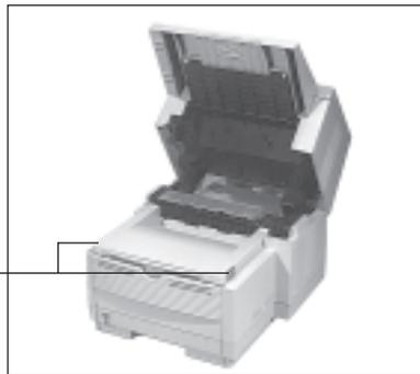
3. Öffnen Sie den Gehäusedeckel, indem Sie die beiden seitlich angebrachten Entriegelungstasten drücken und den Deckel nach oben klappen. Die LED-Zeile befindet sich auf der Unterseite des Gehäusedeckels.
