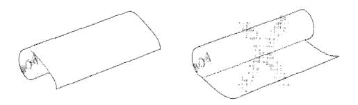
5 Wickeln Sie ein Stück Empfangspapier von der Rolle ab, und führen Sie es nach vorn über die Andruckwalze etwa 5 cm aus dem Gerät heraus.
