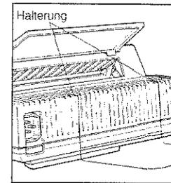
Der Auffangkorb aus Metalldraht wird an der hinteren Gehäusewand des Fernkopierers befestigt.
