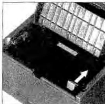
7. Schieben Sie mit etwas Druck den blauen Hebel an der rechten Seiten der Tonerkassette nach vorne (zur Rückseite des Faxgerätes hin). Hierdurch wird die Tonerkassette im Faxgerät verriegelt und der Schlitz auf der Unterseite der Kassette geöffnet.
